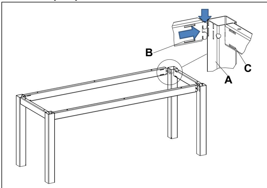
Установить соединители поперечные **В** и продольные **С** на стойки **А**.
