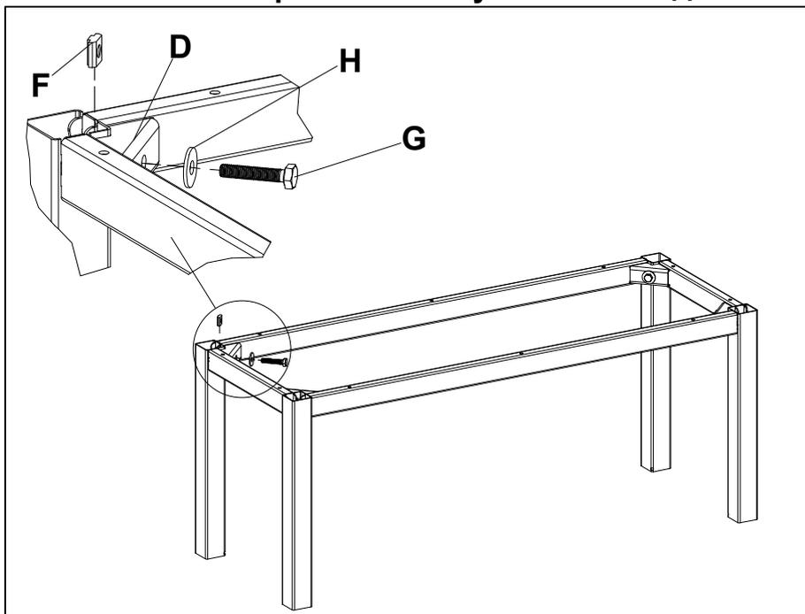
Установить на каркас скамейки кронштейн углового соединения **Д** при помощи болтов **Г** (M8x40), шайб широких **Н** и гаек закладных **Ф**.
